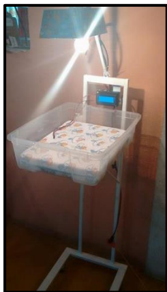
Ilustración 5 -Cuna radiante encendida y en funcionamiento
