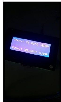
Ilustración 12 – Módulo de control mostrando lecturas de temperatura
