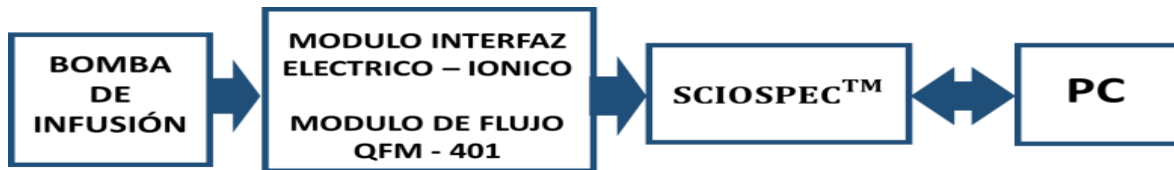
Figura 1 Diagrama a bloques del diseño del sistema biosensor cADN.
